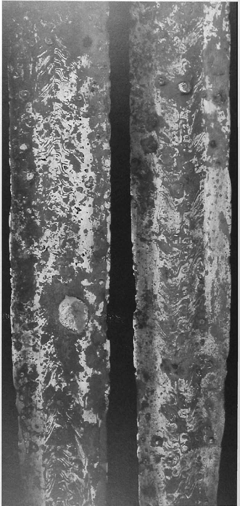
→ Photographs prepared at the Bundesanstalt für Materialforschung und-prüfung, Berlinprüfung of the pattern-welding of this blade.
